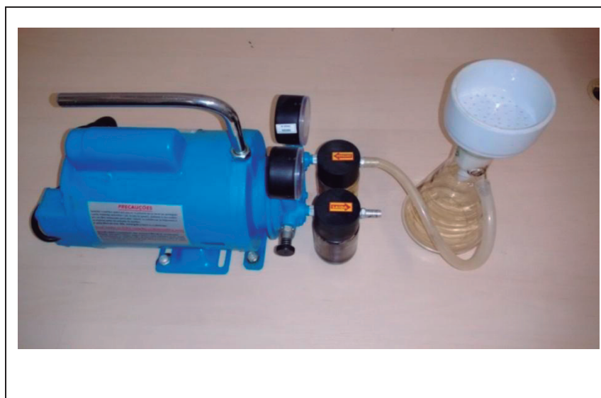
Figura 12. Montagem experimental para processo de filtração a vácuo da mistura galactose + LIP.
