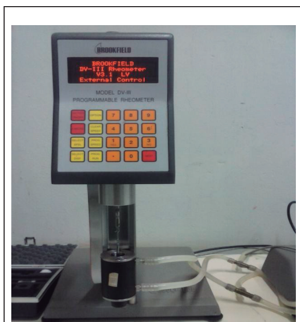
Figura 10. Reômetro utilizado para medir a viscosidade - Brookfield Digital Rheometer Model DV – III.
