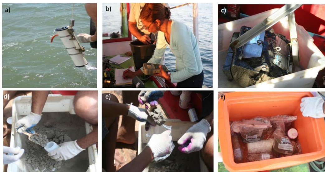
Figura 1 - Procedimentos de campo: a) Coleta de água de fundo, b) Aferição dos parâmetros físico-químicos, c) Coleta de sedimento, d) Acondicionamento das amostras para análise dos bioclastos, e) Acondicionamento das amostras para análise da granulometria, M.O. e carbonato, f) Armazenamento em gelo.
