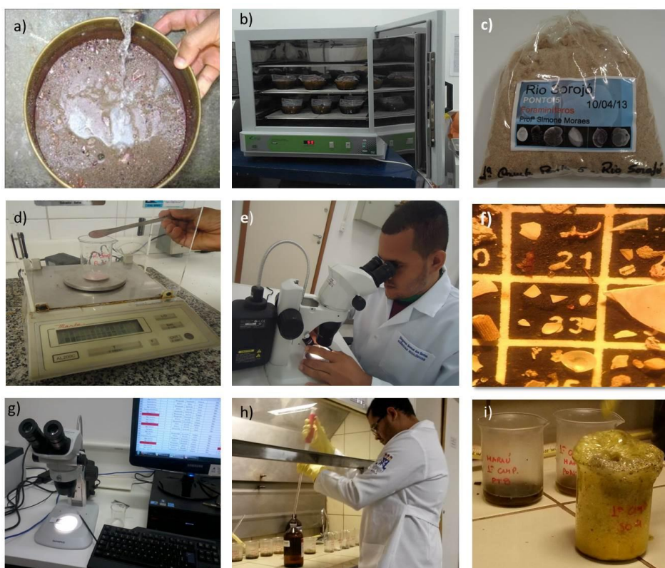
Figura 2 - Procedimentos de laboratório: a) Lavagem das amostras, b) Secagem em estufa, c) Armazenamento e identificação das amostras, d) Pesagem do sedimento, e) Triagem e identificação dos componentes biogênicos, f) Detalhe dos componentes biogênicos no estereomicroscópio, g) Tabulação dos dados no Microsoft Excel, h) Adição do HCl ao sedimentos coletados, i) Detalhes da reação de calcimetria
