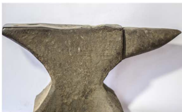
Bigorna (ou safra): Bloco de ferro revestido de aço de corpo central em forma de paralelepípedo e extremidades afinando-se em cone. Serve para moldar o chocalho.
