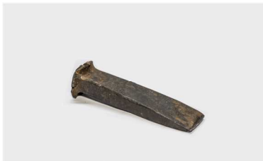
Talhadeira (ou cinzel): É um instrumento que possui uma lâmina de metal muito forte utilizada para cortar a chapa de metal, com o auxílio do martelo.
