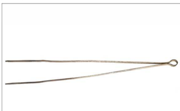
Grampa: Ferramenta comprida, de aço. É utilizada para virar, remexer a bola com os chocalhos dentro do forno e também para retirá-la.
