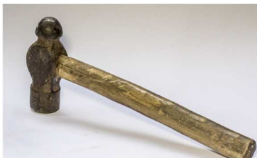
Martelo: Ferramenta de ferro com cabo de madeira utilizada em diversas etapas da fabricação do chocalho: Corte; rebater; acertar, etc.
