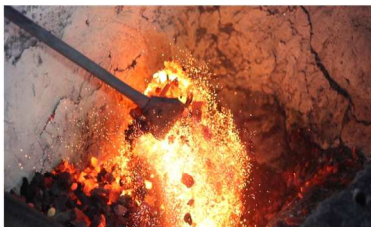
Forno à carvão: Construído de tijolos e argila e aquecido à carvão serve para queimar os chocalhos crus e os chocalhos envoltos na bola de argila.
