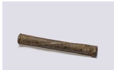
Rebatedor: Instrumento cilíndrico, de ferro, podendo ter base ou não. Serve para fixar a aseia, o travão e para afinar o chocalho.
