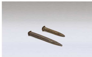
Punção (ou perfurador): É um instrumento pontiagudo, de aço, que o chocalheiro utiliza para fazer os três furos na parte superior do chocalho, com a ajuda de um martelo.
