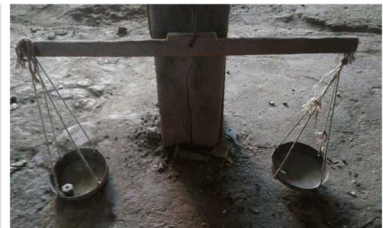
Balança: Produzida artesanalmente, a partir de material reciclado pelos próprios chocalheiros. A balança é utilizada para pesar o latão que vai dentro de cada chocalho.
