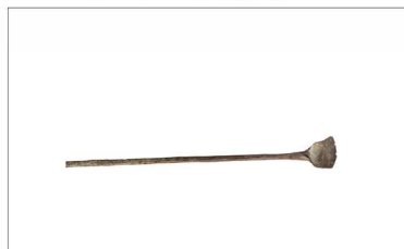
Pá (chegadeira): Ferramenta utilizada para mexer e puxar o carvão dentro do forno, conforme a necessidade para queima da bola.
