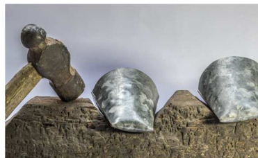
Concavador (ou cascovador): É uma peça de madeira com cortes côncavos em sua superfície. Serve para moldar a chapa cortada e dar o formato de chocalho.
