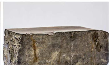
Aguião: Peça retangular de ferro utilizado como suporte para o corte da chapa de metal.
