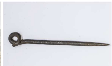
Riscador (ou riscadeira): Instrumento pontiagudo de aço semelhante a um lápis, utilizado para riscar o molde do chocalho na chapa.
