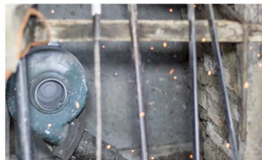
Ventoinha (venturina): Motor elétrico utilizado para acender e manter o forno aquecido durante todo o processo de fabricação de chocalho.
