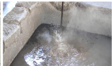
Tanque d'água: pequeno reservatório de água, não muito profundo, onde colocam-se as bolas de barro retiradas do forno para que esfriem por completo.
