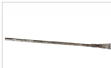
Cavadeira reta (cavador): Peça de aço com um cabo de madeira. Serve para desobstruir a cavidade dentro do forno por onde entra o vapor do motor que aquece o carvão.
