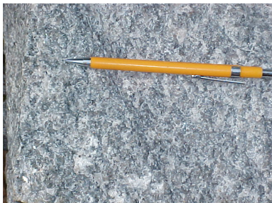
Foto 19: Textura fanerítica média a grossa do nefelina-sienito (Pedreira São Joaquim). [AM] 2575, [P] 849.
