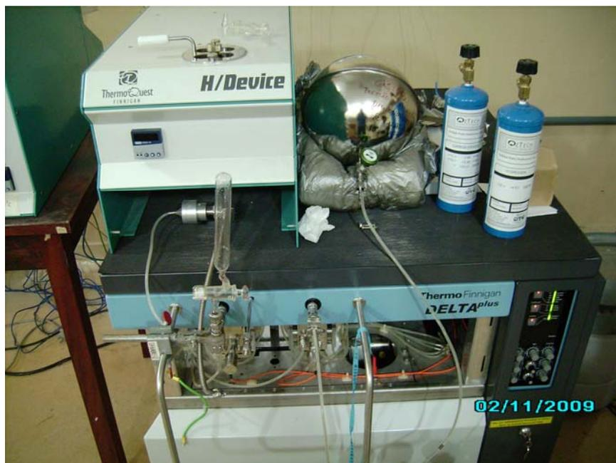
Figura 26: Espectrômetro de massa utilizado no estudo.
