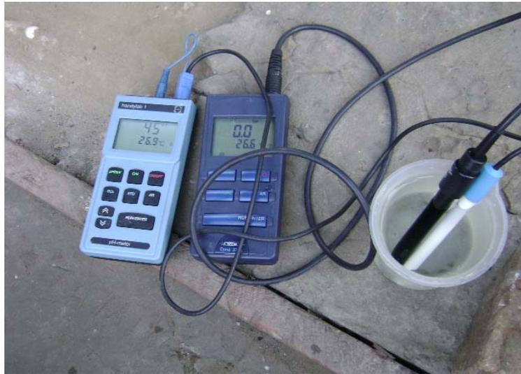
Figura 23: Aparelhos utilizados para medida de pH, condutividade, temperatura da água, OD e Eh.
