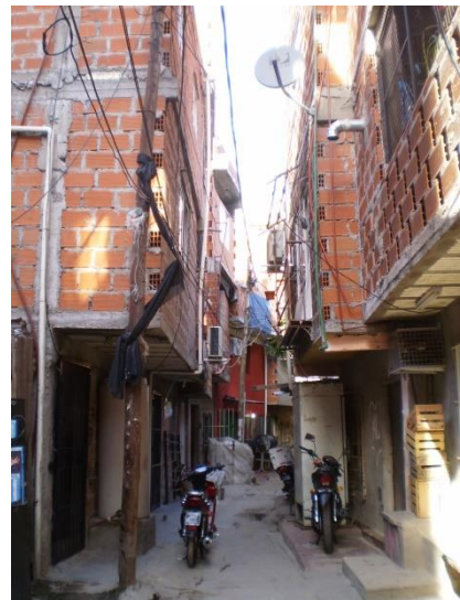
Fotos 6 e 7: Conexões irregulares à energia elétrica e estreitos corredores sem saída já provocaram vários incêndios no lugar.
