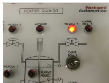
(b) Abertura da válvula de vapor
