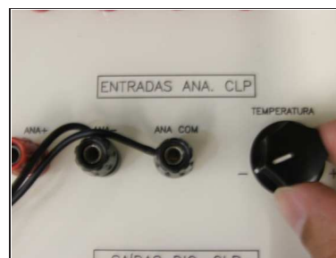
(c) Simulação do aumento da temperatura para 100°C
