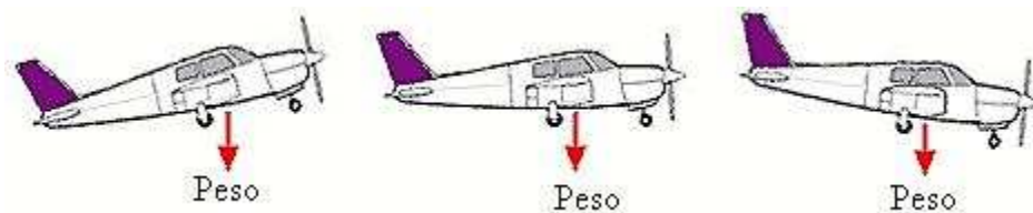
Figura 22 - Direção e sentido da força peso.
