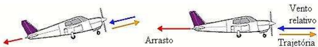
Figura 23 - Direção e sentido do arrasto.
