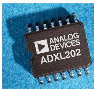
Figura 42 - Circuito Integrado contendo um Acelerômetro.
