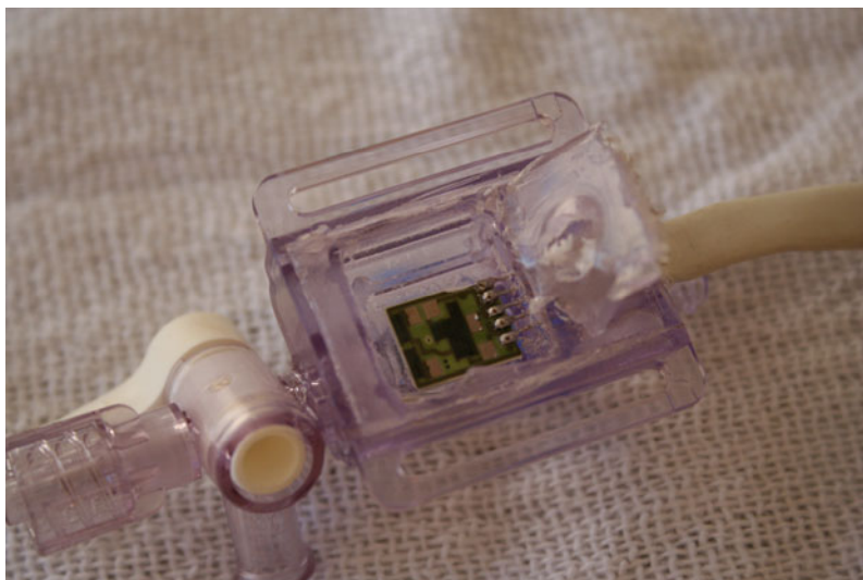
Figura 5.2: detalhe do TPS sem a tampa do sensor após a desmontagem.
