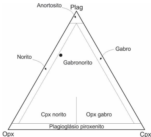
Figura 3.13 – Classificação modal de rochas gabróicas baseada nas proporções de ortopiroxênio (Opx), clinopiroxênio (Cpx) e plagioclásio (Pl) (STRECKEISEN, 1976).
