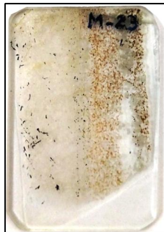
Figura 5.1 - Fotografia da lâmina delgada M-23, exibindo duas faixas de ocorrência dos minerais, separando-a ao meio (faixa esquerda e direita).
