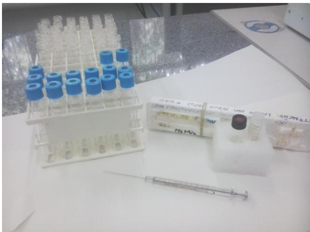
Fotografia 3.9: Vial, ácido e seringa utilizados na preparação de amostras para análise de \delta^{13}\text{C}_{\text{DIC}} .
