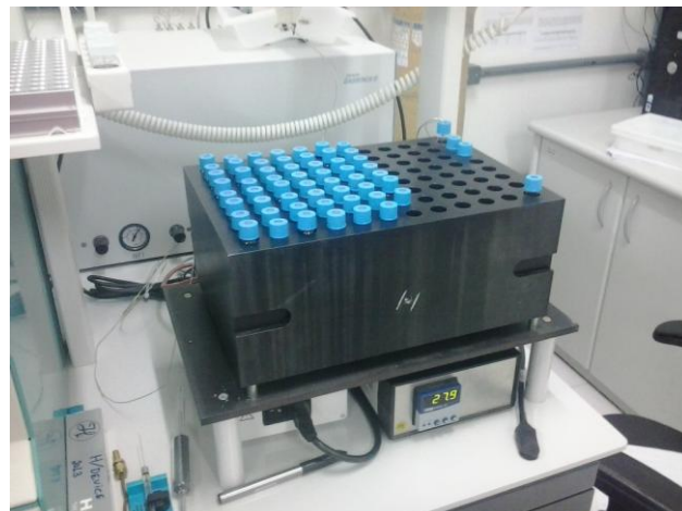
Fotografia 3.10: Amostras preparadas inseridas no Finningan GasBench .
