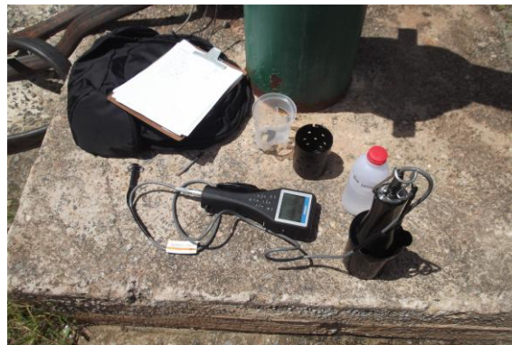
Fotografia 3.2: Multiparâmetro e frasco utilizado para armazenamento da amostra.
