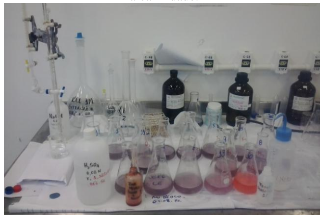
Fotografia 3.4: Ensaio analítico para determinação de alcalinidade.
