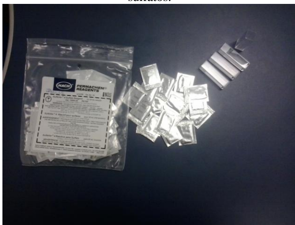
Fotografia 3.5: Reagente e cubetas utilizados na análise de sulfatos.
