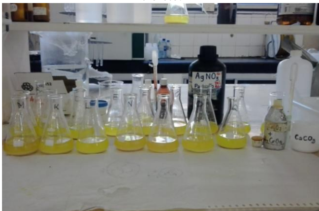
Fotografia 3.3: Ensaio analítico para determinação do cloreto.
