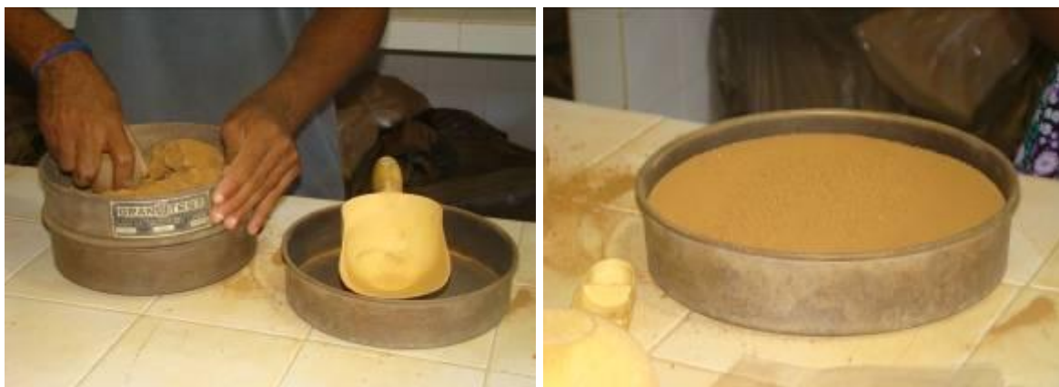
Figura 4.1.4-1. Processo de destorroamento e peneiramento para obtenção da TFSA.
