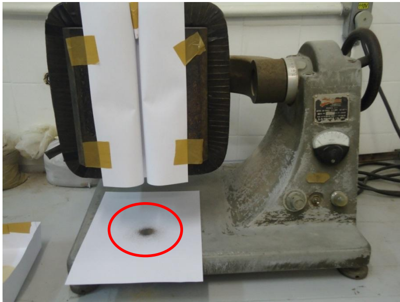
Figura 4.1.4- 11. Resultado da atração dos minerais magnéticos.
