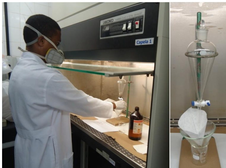
Figura 4.1.4-12 Preparação de amostra dos minerais magnéticos e funil de separação dos minerais leves e pesados.
