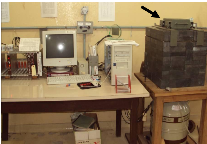
Figura 13. Espectrômetro de radiação gama (indicado na seta), do Laboratório de Física Nuclear da Universidade Federal da Bahia, o qual foi utilizado para medir a atividade radioativa do Pb^{210} .
