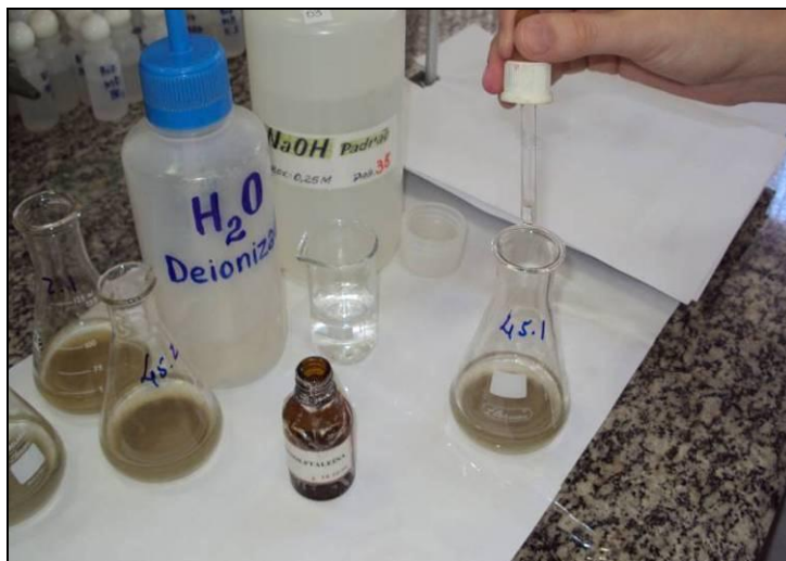
Figura 18. Adição de três gotas de fenolftaleína nas amostras para titulação.
