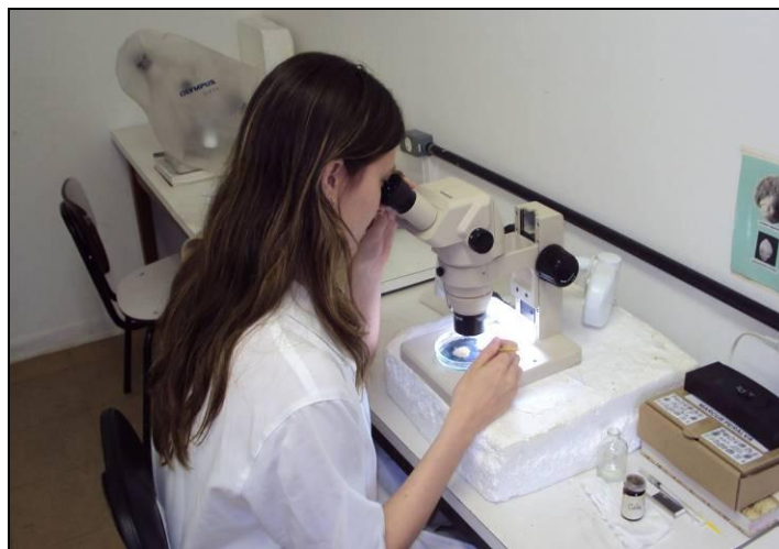
Figura 21. Análise da composição do sedimento arenoso sob lupa binocular.
