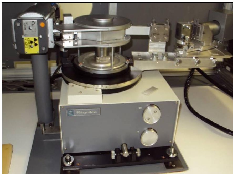
Figura 22. Difratorômetro de raios-X utilizado para análise dos argilo-minerais presentes nas amostras da fração lama.
