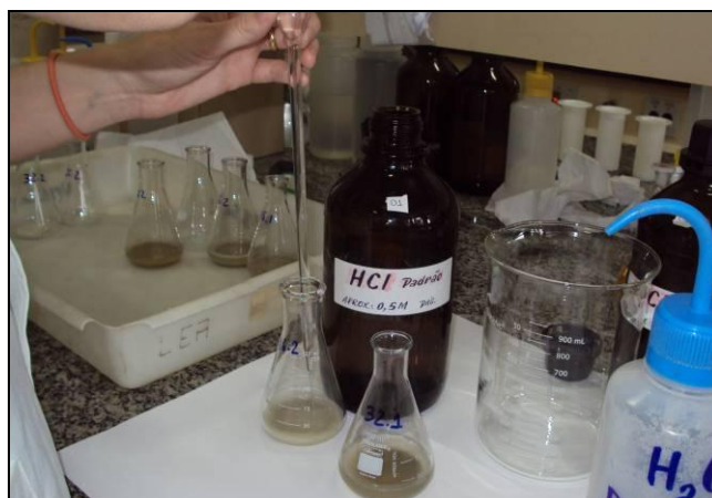
Figura 16. Adição de HCl nas amostras para titulação.
