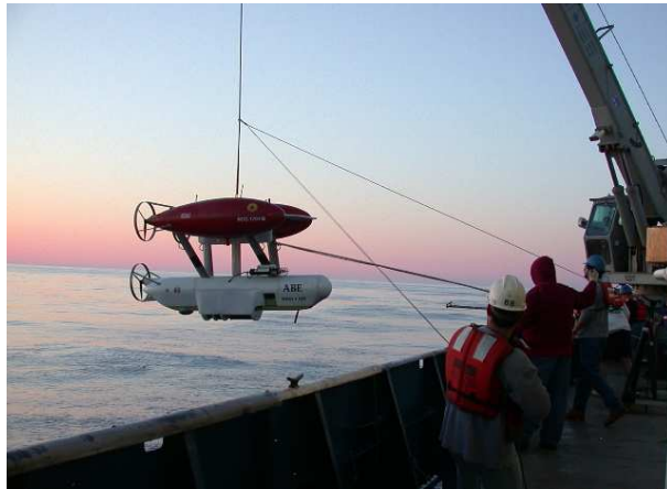
Figura 2.2. ABE (Autonomous Benthic Explorer) sendo resgatado após mapeamento de fluxo de calor em Juan de Fuca Ridge.
