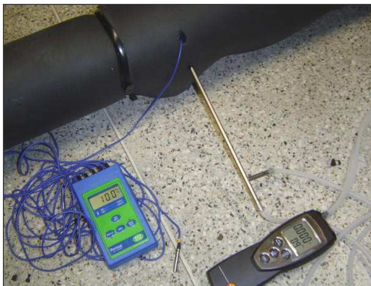
Figura 84 – Detalhe do anemômetro padrão e termômetro para calibração e testes.
