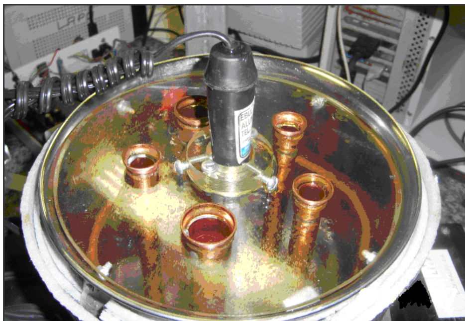
Figura 37– Detalhe do banho termostático para caracterização de sensores termoresistivos.
