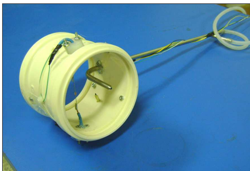
Figura 85 – Trecho reto de duto usado para fixação dos sensores do anemômetro e do tubo de Pitot.
