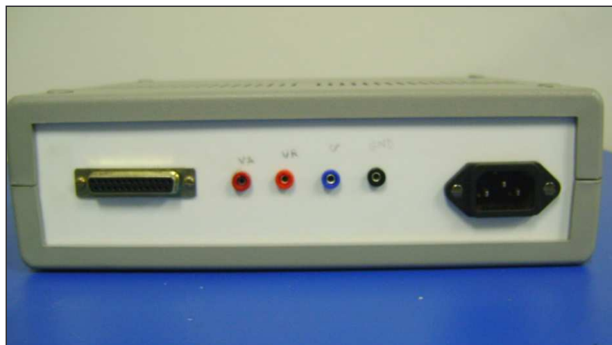
Figura 53 – Vista frontal da caixa de montagem do sistema de aquisição de dados.
