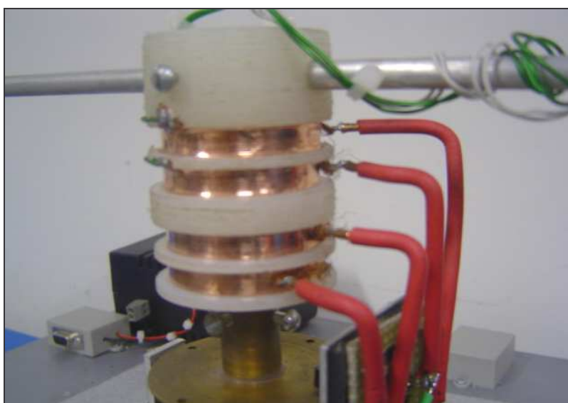
Figura 64 – Detalhe das trilhas da escove elétrica.
