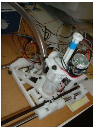
Figura 17 - Primeiro extrusor desenvolvido pela equipe RepRap (BOWYER, 2004).
