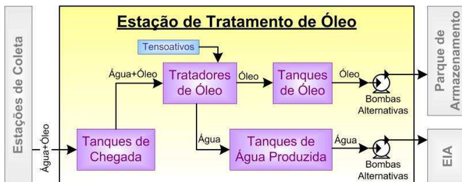
Figura 65 – Visão geral de uma estação de tratamento
