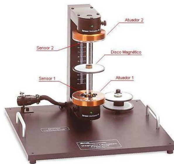
Figura 3: Foto do sistema físico de levitação magnética da ECP.
