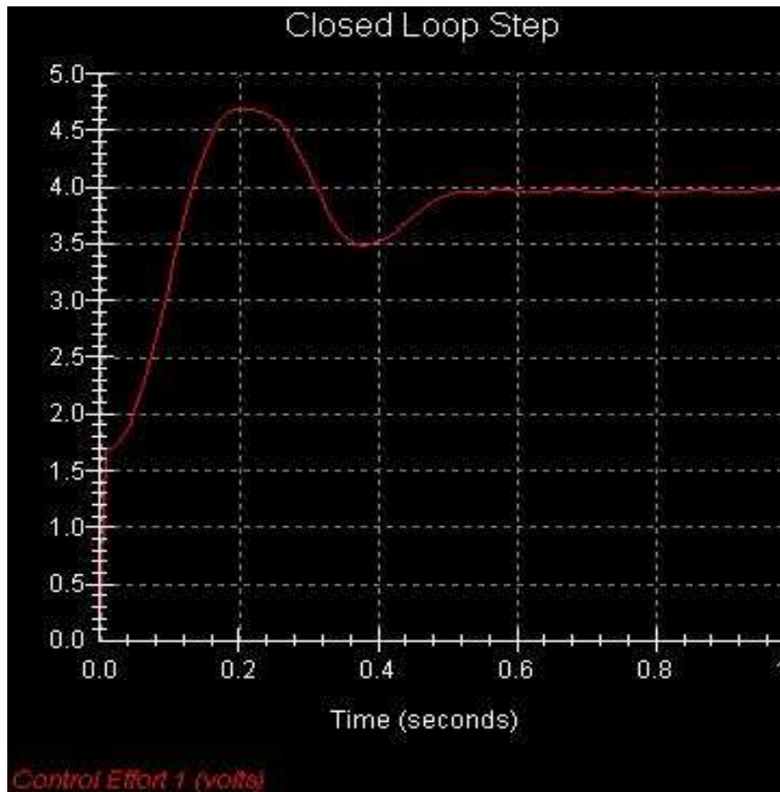
Figura 17: Esforço de controle (comportamento da tensão aplicada à bobina).
