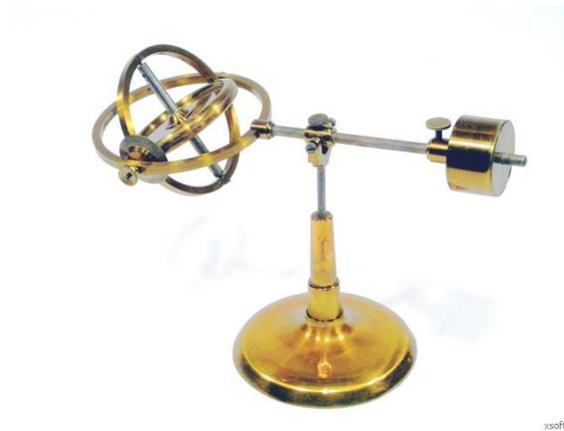
**Figura 7.** Aspeto de um giroscópio clássico.
