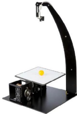
**Figura 13.** Aspecto do equipamento *Ball-Balancer* da Quanser<sup>TM</sup>.
