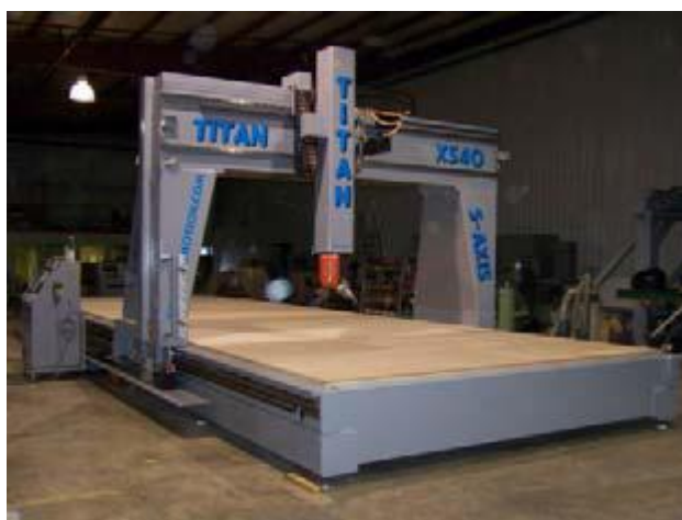
Figura 32: Exemplo de máquina corrigir a referência e trocas as figurastipo portal (MIRALLES, 2009)
