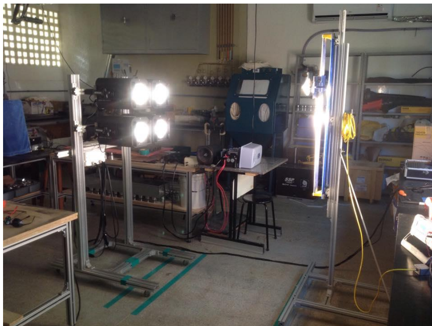
Figura 31: Teste de não uniformidade para 4 holofotes espaçados duas polegadas em configuração quadrada.
