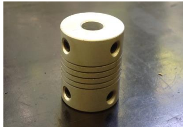
Figura 14: Acoplamento flexível \varnothing 6\text{mm} \times \varnothing 6,35\text{mm} \times 25\text{mm} utilizado para transmitir o torque do motor ao parafuso sem fim do holofote.
