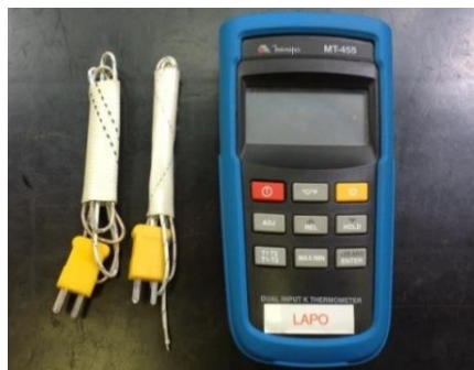
Figura 17: Termômetro digital marca Minipa, modelo MT-455, com dois termopares para determinar o comportamento térmico interno dos holofotes.
