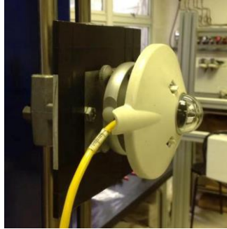
Figura 29: Piranômetro Kipp-Zonen modelo CMP-21.
