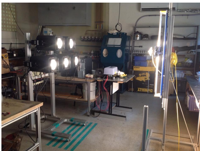
Figura 32: Teste de não uniformidade para 5 holofotes espaçados 5 polegadas em configuração triangular.
