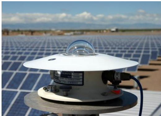
Figura 5: Exemplo de um piranômetro instalado para a medição da radiação solar em um campo solar.
