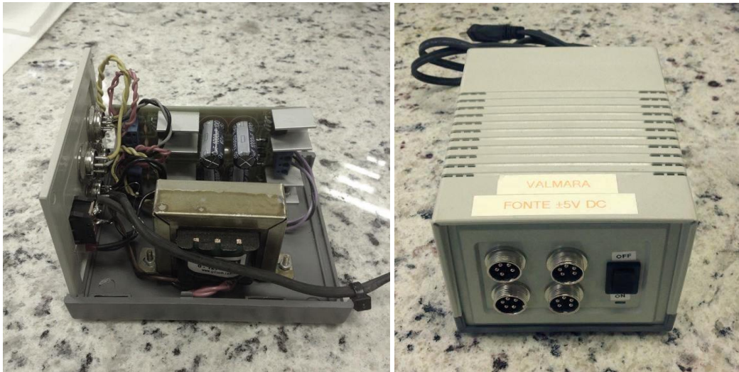
Figura 8 - Fonte de alimentação do sistema de detecção, fonte simétrica \pm 5 Vdc para até 4 pré-amplificadores.
