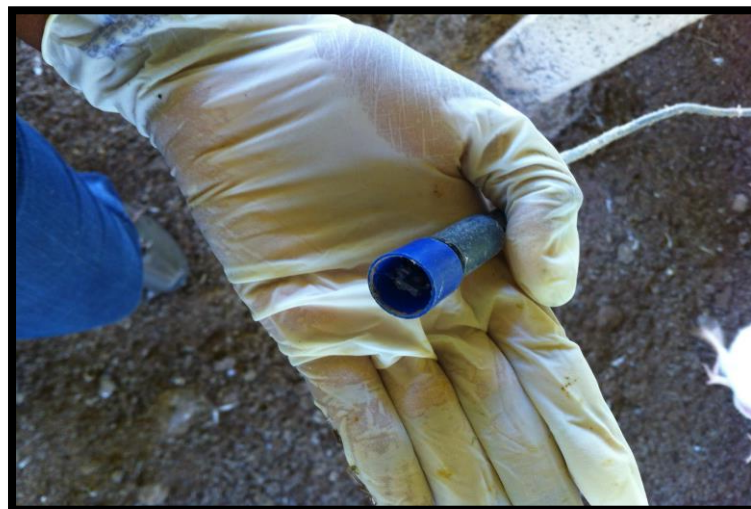
Ilustração 4-Aparelho para mensuração da umidade relativa e temperatura no ambiente interno dos galpões. Fonte: Acervo pessoal.
