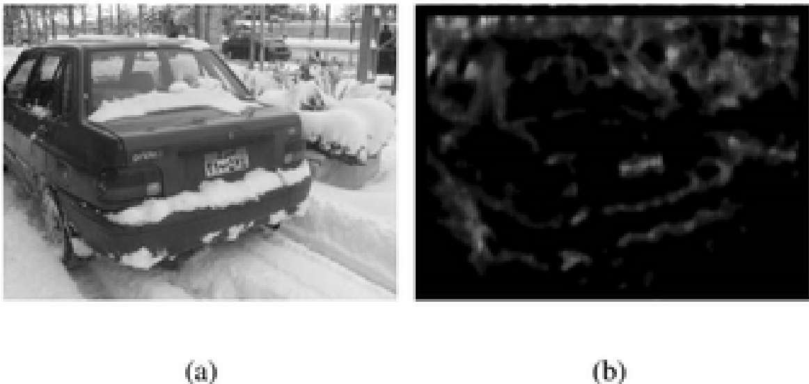
Figura 2.3: Aplicação do filtro bothat e sobel vertical. (a) imagem original, (b) resultado do filtro bothat seguido de sobel em (a). Imagem retirada de [21]
