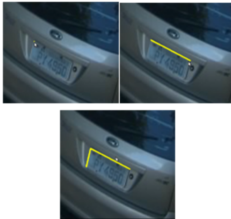
Figura 3.3: Exemplo de um procedimento de corte de imagem de placa utilizando o cortador de retângulos.
