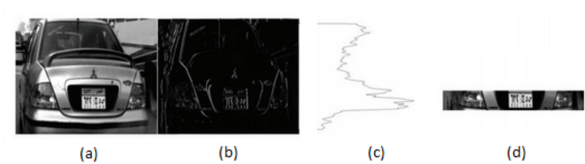
Figura 2.1: Resultados da aplicação do filtro Sobel vertical. (a) Imagem original, (b) sobel vertical, (c) projeção vertical da imagem aplicando threshold, (d) região de maior quantidade de bordas. Imagem retirada de [25].
