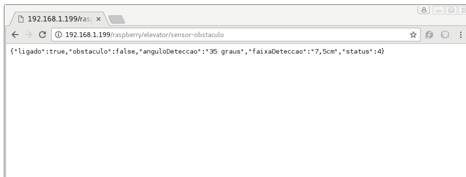
Figura 2.1: Dispositivo sensor de obstáculo do elevador disponibilizado como serviço. Faixa de detecção compatível com a largura do elevador utilizado na maquete do cenário (Figura 3.3)
