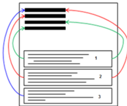
Figura 2.1 Classe exemplificando cálculo de LCOM.
