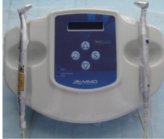
Figura 04 - Aparelho utilizado no experimento para realização da fototerapia laser (Twinflex Evolution ® , MMOptics, São Carlos, SP, Brasil) (ROSA, 2014).
