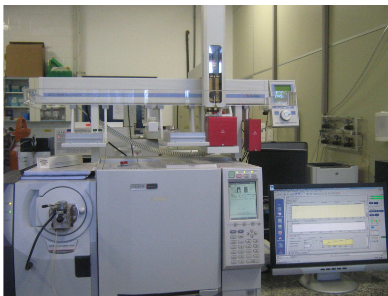
Figura 18. Sistema SPME-GC-MS utilizado na determinação e otimização das condições de extração dos agrotóxicos na matriz manga.
