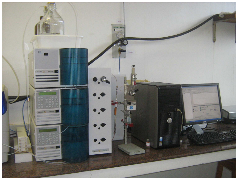
Figura 20. Sistema utilizado para a determinação de resíduos de agrotóxicos da matriz manga por SPME-HPLC-UV-Vis .
