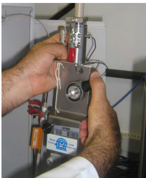
Figura 29a. Válvula na posição “load”.
