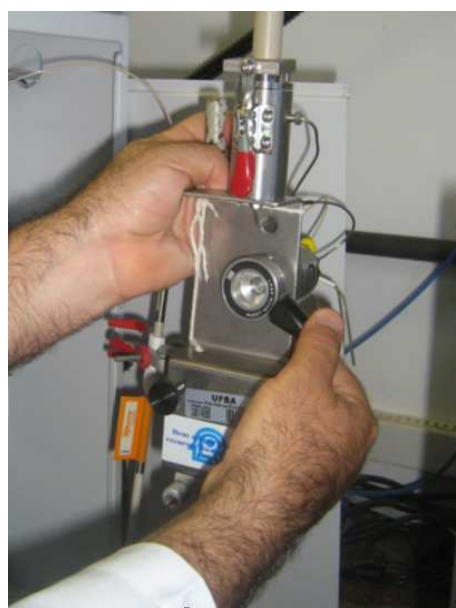
Figura 29b. Válvula na posição “inject”.
