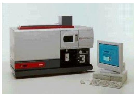
Figura 07 - Equipamento ICP OES utilizado neste trabalho e a tocha na configuração axial.
