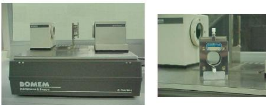
Figura 08: Instrumento empregado para as medidas na região NIR (com detalhe da cela de medida).
