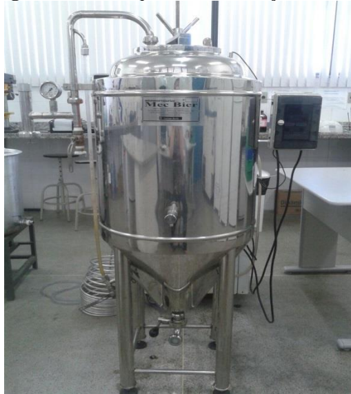
Figura 4.17- Tanque de Fermentação.
