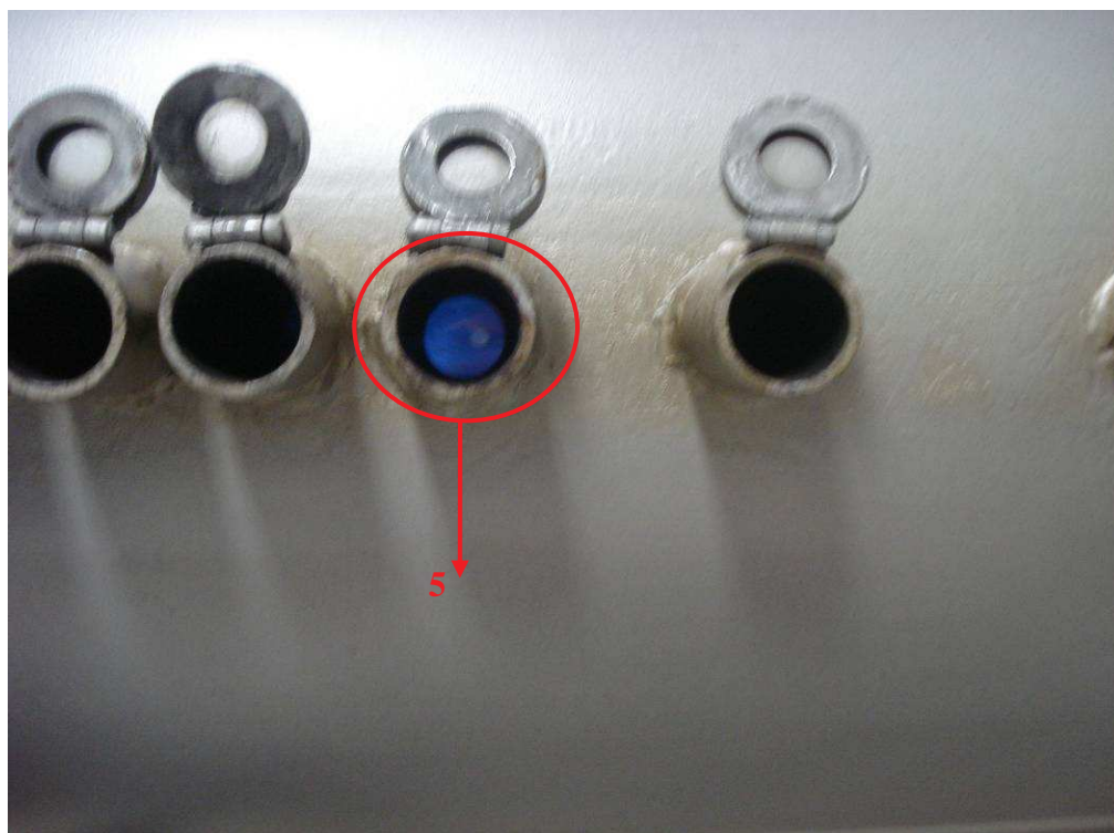
Figura 6.28: Aspecto visual da chama de gás natural sendo queimado com ar puro.
