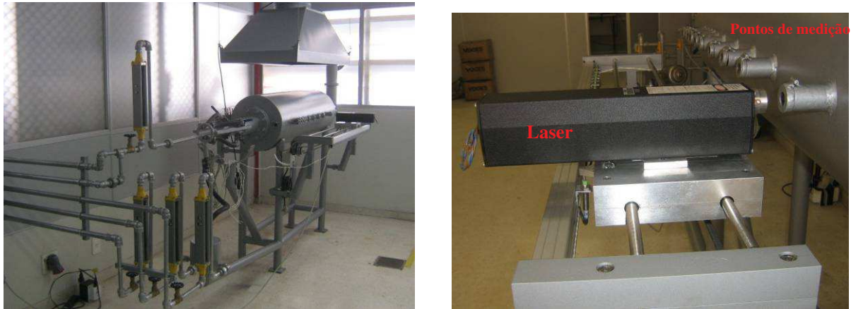
(a) Vista da Câmara de Combustão e dos Rotômetros. (b) Vista do sistema de laser e pontos de medição de fuligem.
