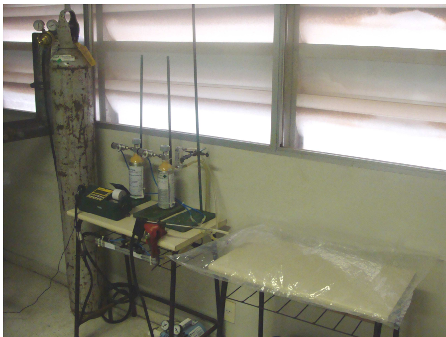
Figura II.1. Sistema de calibração em laboratório para a medição de NO e NO 2 .
