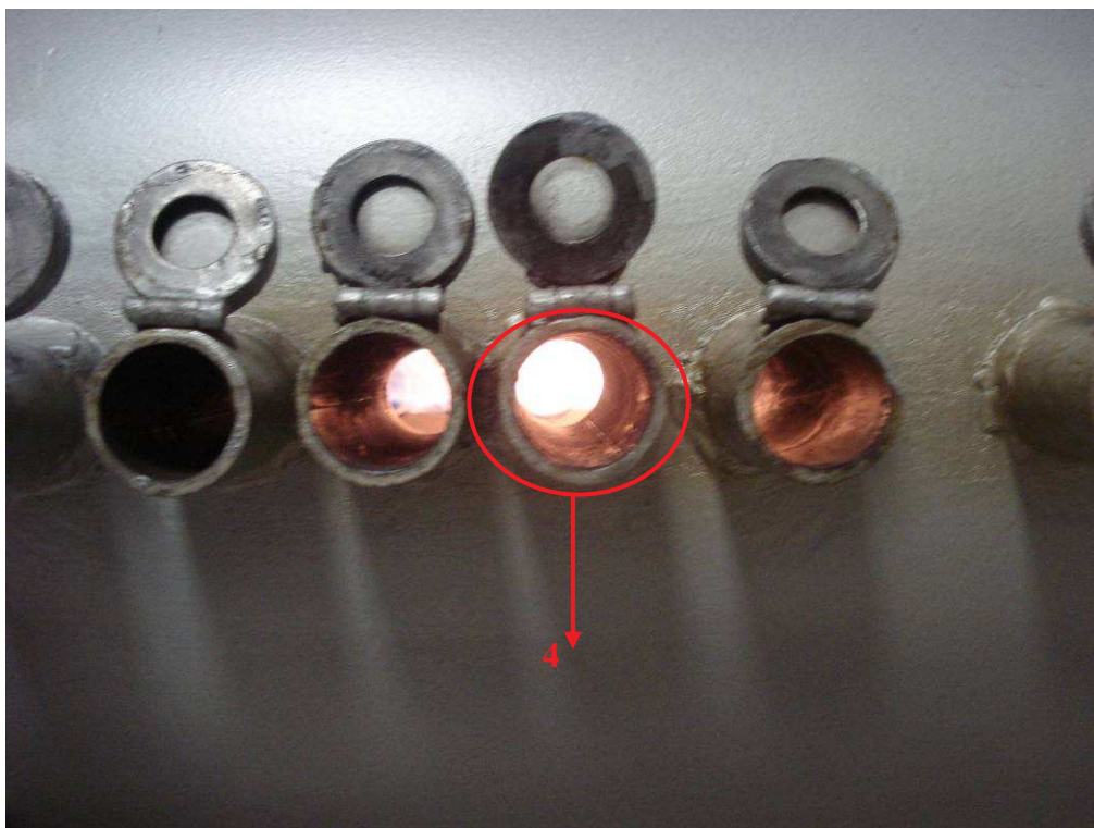
Figura 6.29: Aspecto visual da chama de gás natural sendo queimado com ar enriquecido com O_2 .
