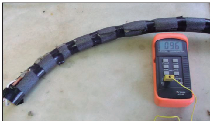
Figura 3.39 - Fixação da resistência de aquecimento e isolamento térmico na linha de amostragem.
