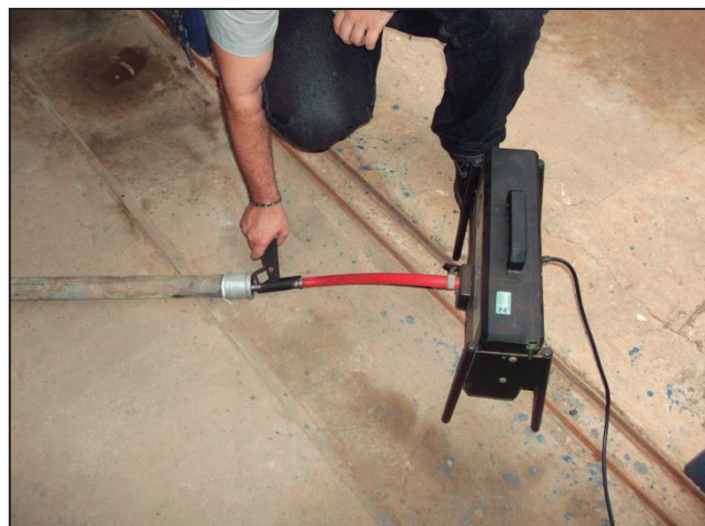
Figura 3.16 - Posicionamento da sonda do opacímetro na descarga do motor.
