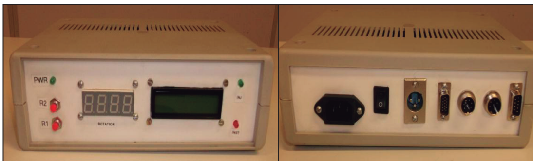
(a) (b) Figura 3.5 - Vistas anterior (a) e posterior (b) do gabinete da ECU.
