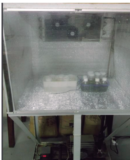
Figura 3.24 - Câmara climatizadora para amostras.
