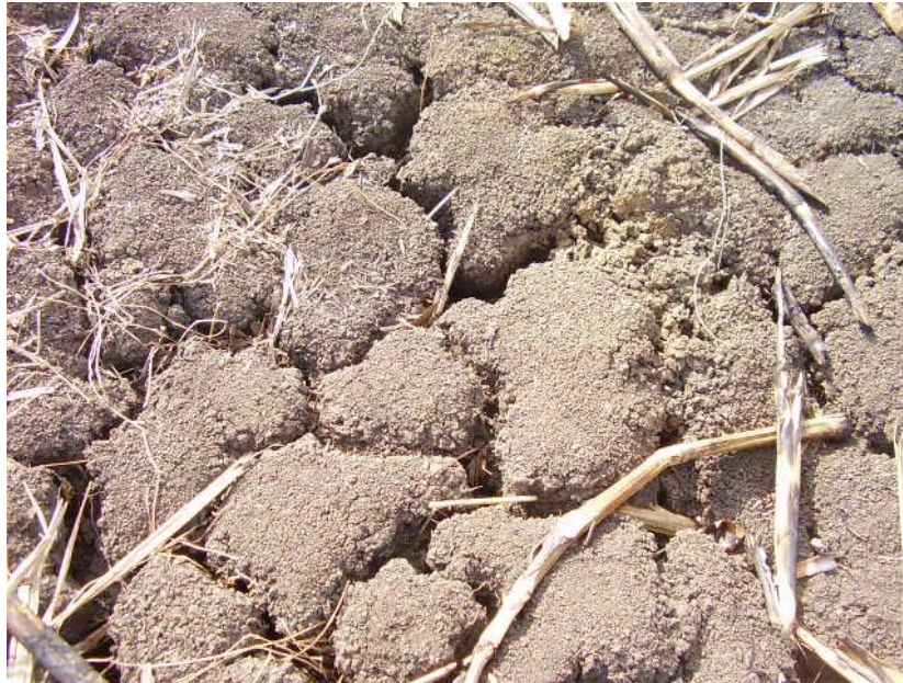
Figura 10 – Feição típica de solo com características vérticas
