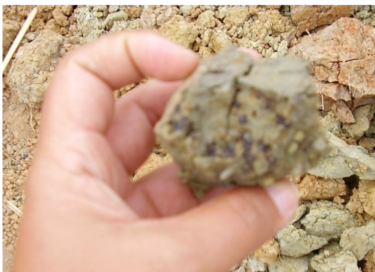
Figura 18 – Concreções de Mn retiradas do horizonte CR no perfil do Luvissole Crômico Órtico planossólico vértico (TCo).
