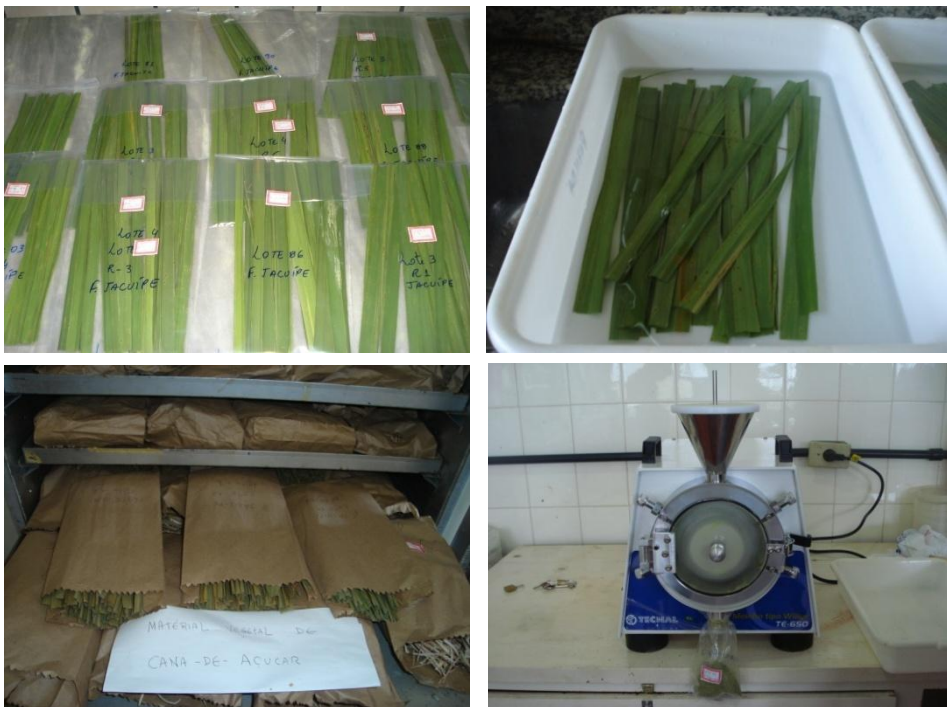
Figura 5 – Corte, lavagem, secagem e trituração do tecido foliar utilizado na extração.
