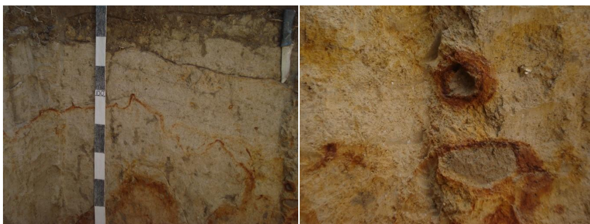
Figura 19 – Presença de linha de ferro no perfil do Argissolo Amarelo Distrocoeso arênico fragipânico espódico (PA dx ).
