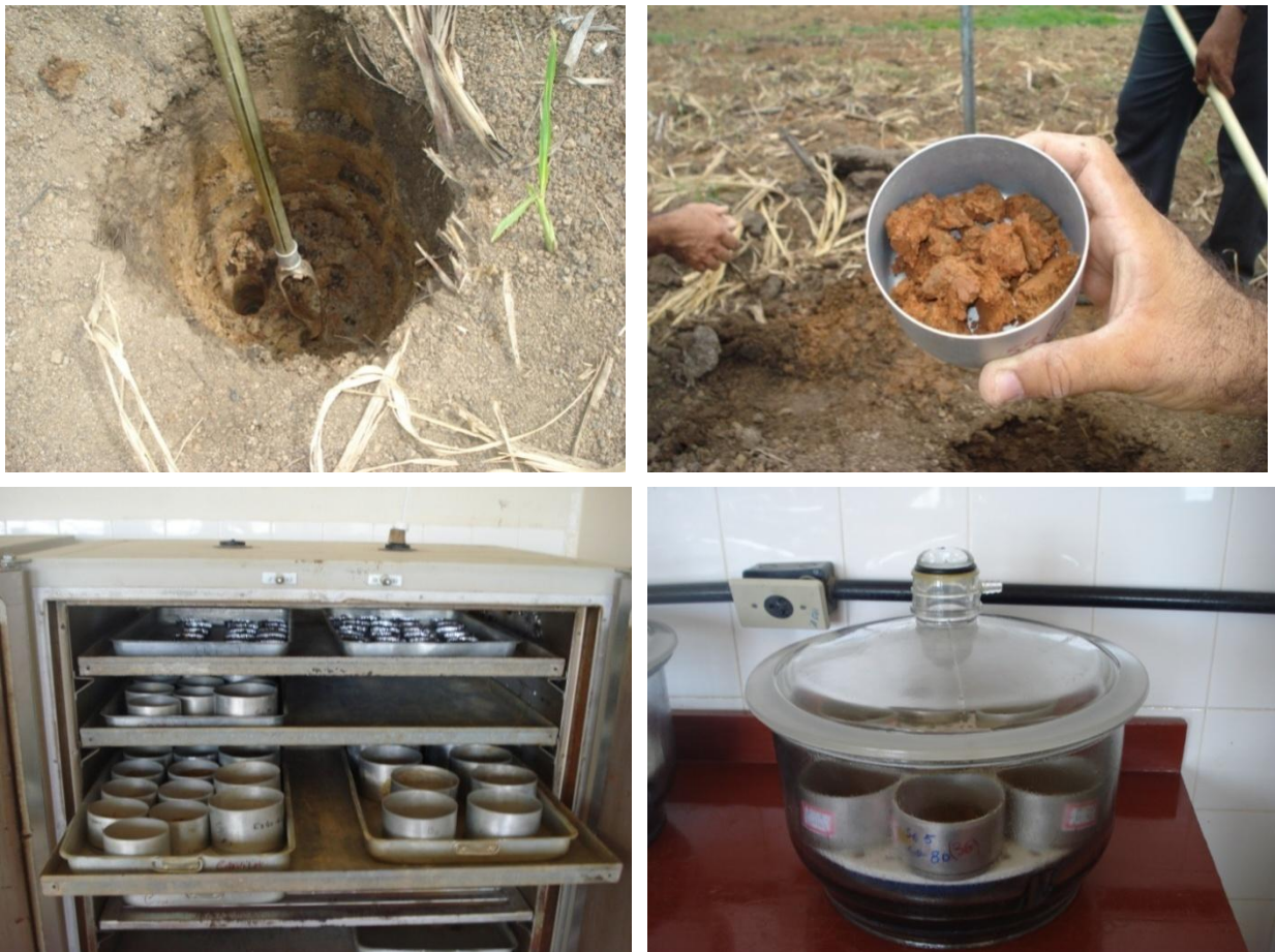
Figura 8 – Coleta de amostras de terra em diferentes profundidades e sequência de procedimentos analíticos para determinação da umidade do solo.
