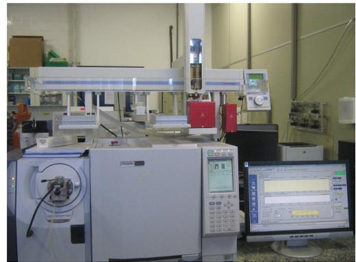
Figura 19- Cromatógrafo Shimadzu GC-QP 2010.
