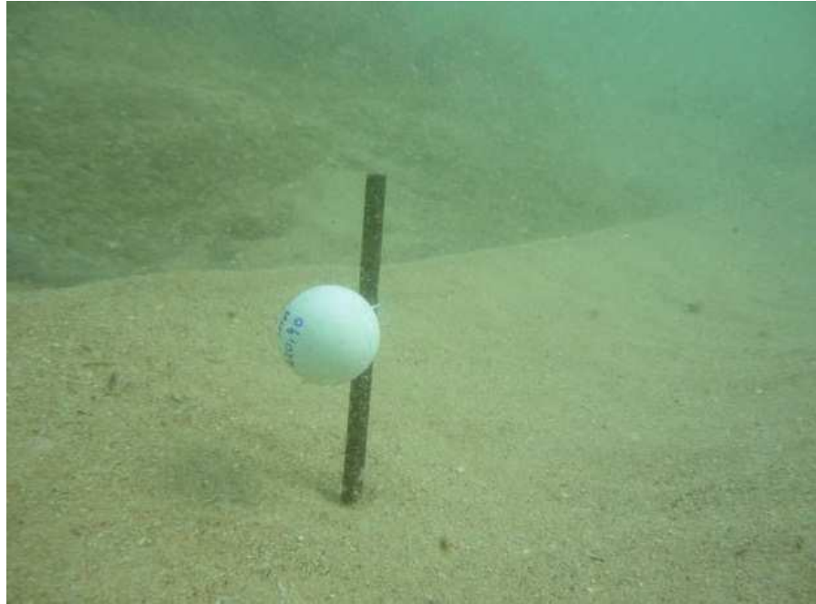
Anexo 13. Bola de gesso colocada para averiguar gradiente de exposição de ondas.
