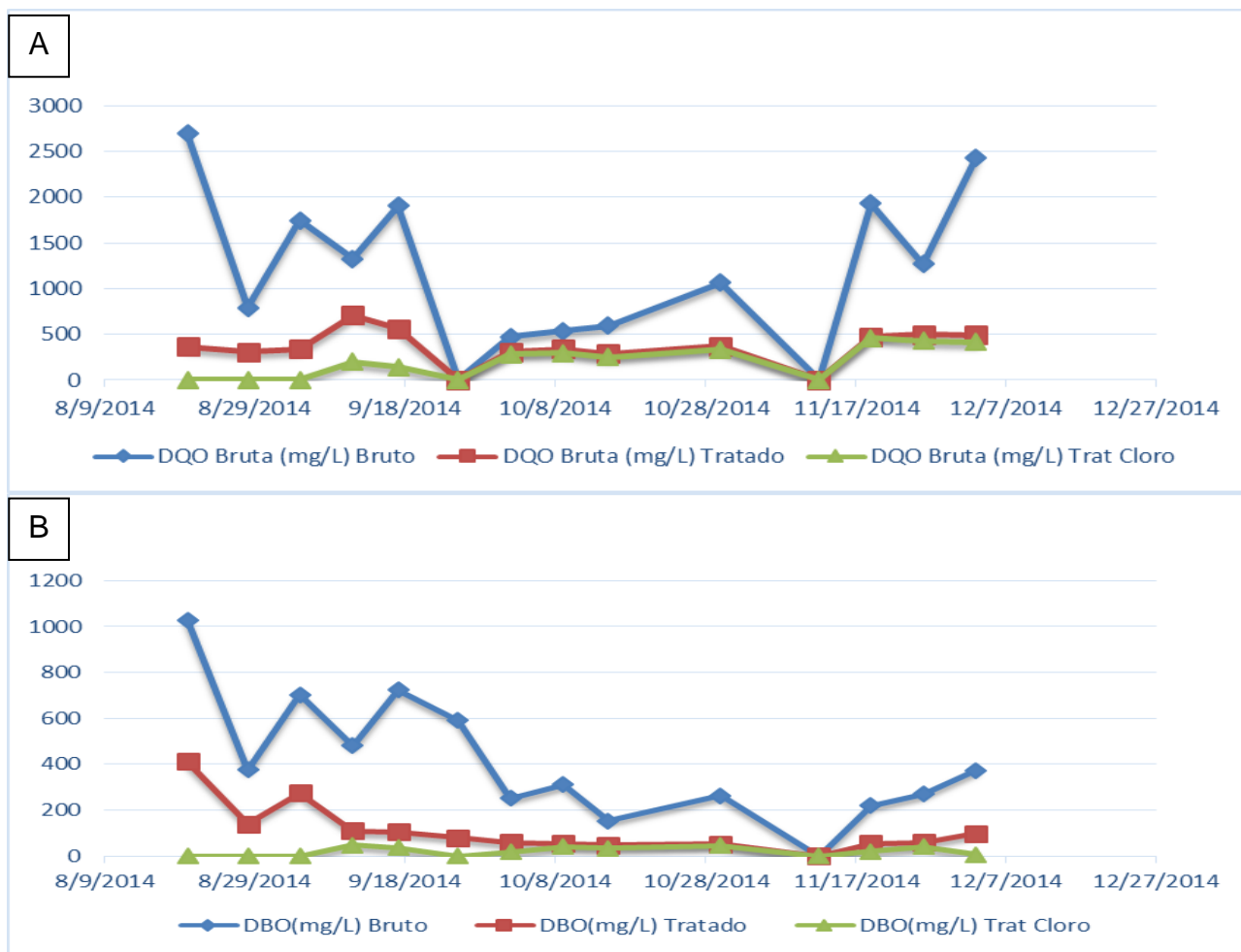
Figura 12. Demanda Química (A) e Bioquímica (B) de Oxigênio do efluente antes e após o módulo de tratamento com e sem cloração.
