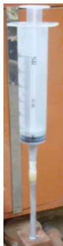
Figura 35. Injeção do epóxi no furo (Fonte: O autor).
