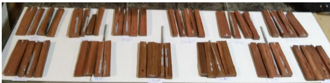
Figura 49. Registro fotográfico de defeitos de colagem (Fonte: O autor).
