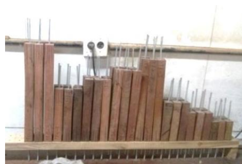
Figura 41. Cura do adesivo no suporte (Fonte: O autor).
