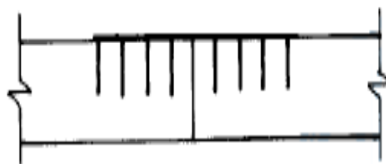
Figura 7. Ligação mecânica com chapa com dentes (ABNT, 1997).
