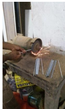
Figura 38. Desbaste das pontas das barras (Fonte: O autor).
