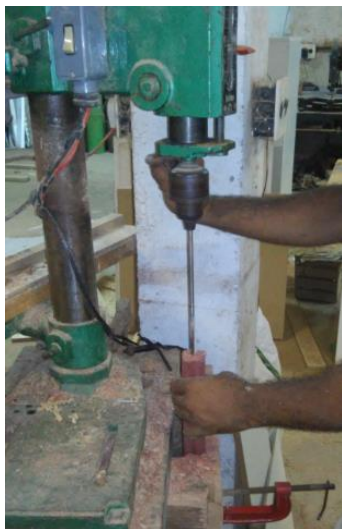
Figura 29. Furação dos blocos de madeira (Fonte: O autor).
