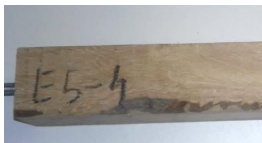
Figura 54. Bolsa de resina em CP de Citriodora (Fonte: O autor).
