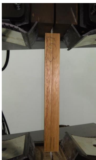
Figura 46. Ensaio de tração em CP (Fonte: O autor).
