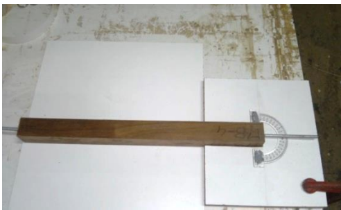
Figura 43. Medição de \theta do CP M8-4 - visão geral (Fonte: O autor).
