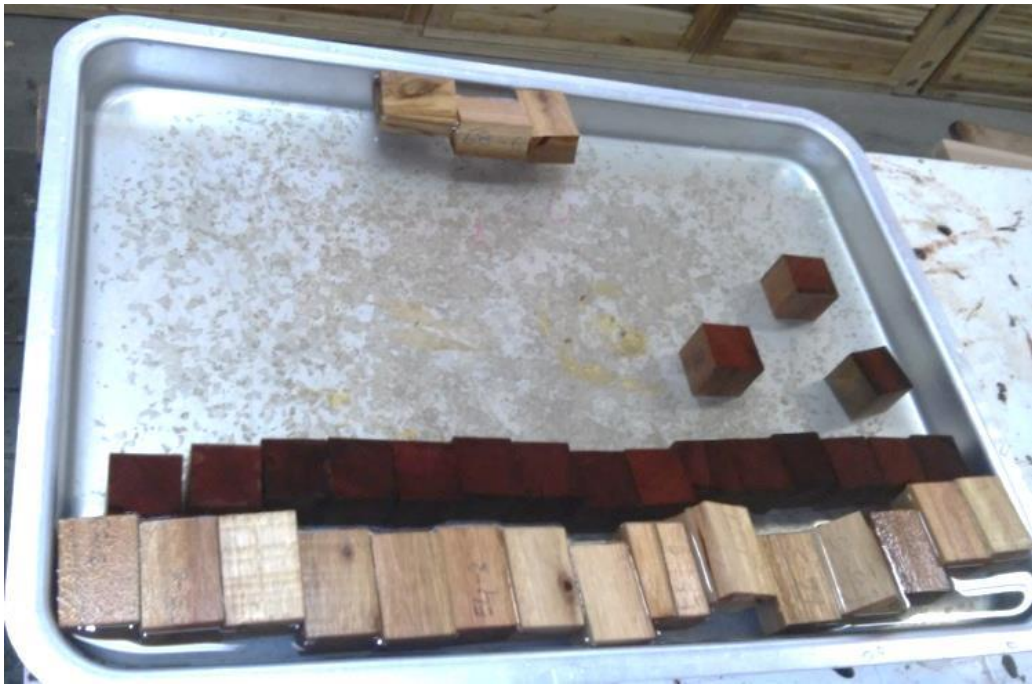
Figura 52. Saturação dos CPs em água (Fonte: O autor)
