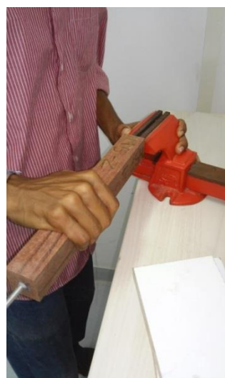
Figura 47. Dobramento da barra do CP (Fonte: O autor).
