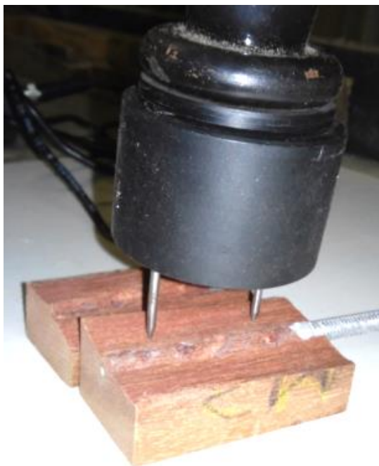
Figura 50. Medição da umidade junto à linha de colagem (Fonte: O autor).
