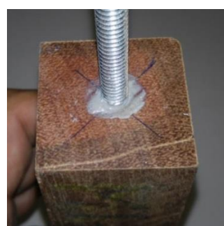
Figura 56. Rachadura em CP de Maçaranduba (Fonte: O autor).
