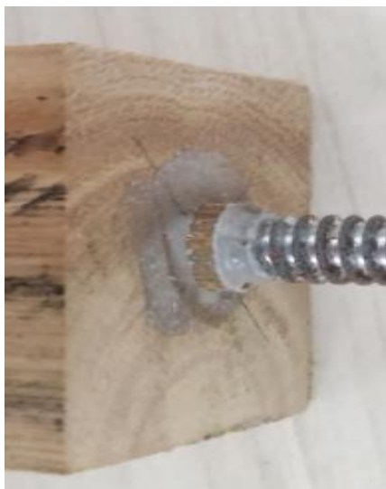
Figura 59. Cisalhamento da madeira em CP sem defeitos (Fonte: O autor).
