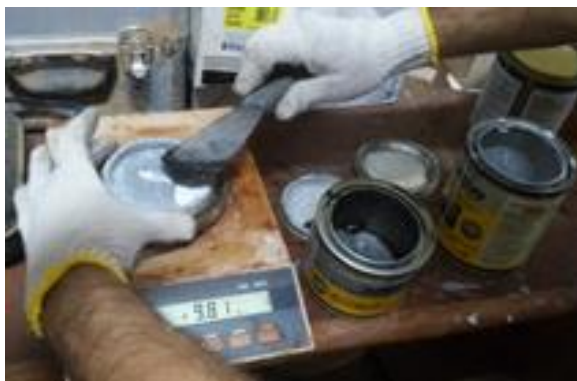
Figura 32. Mistura dos componentes do epóxi (Fonte: O autor).
