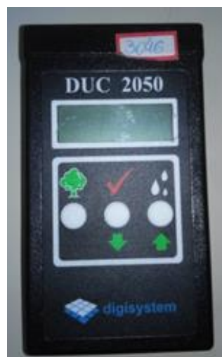
Figura 27. Xilohigrômetro de contato (Fonte: O autor).
