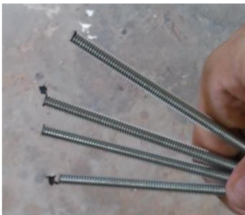
Figura 37. Extremidades das barras após o corte (Fonte: O autor).
