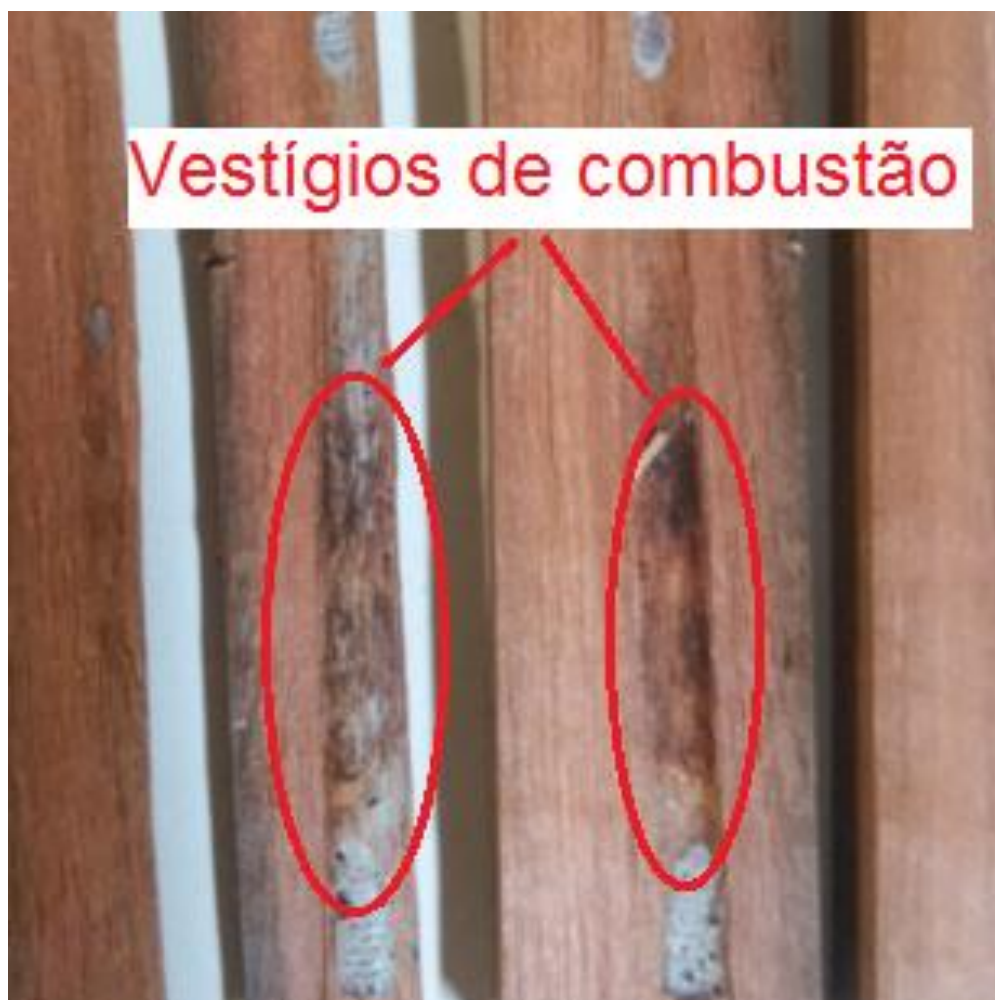
Figura 57. Combustão pontual na linha de colagem (Fonte: O autor).
