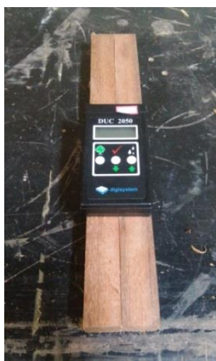
Figura 26. Medição da umidade do CP (Fonte: O autor).
