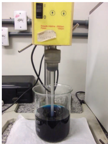
Figura 3.3 Aparato experimental de remoção do azul de metileno.
