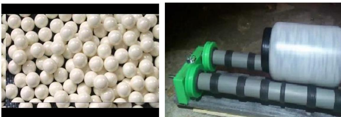
**Figura 5.2:** (Esquerda) Esferas de  $ZrO_2$  e (Direita) *ball-miller*.
