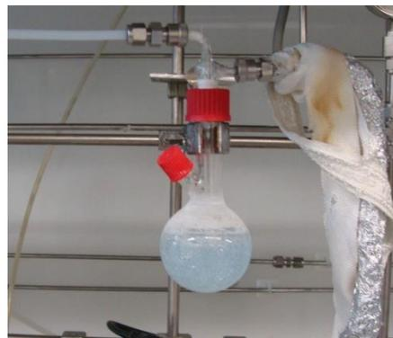
**Figura 5.8:** Saturador utilizado para obter vapor de HAC.
