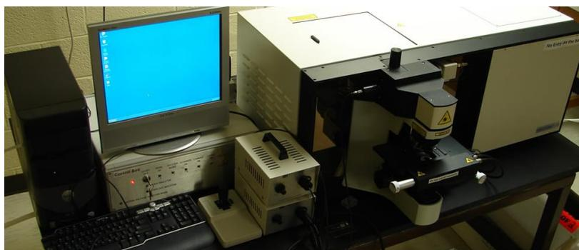
**Figura 5.11:** Imagem do espectroscópio Raman utilizado neste trabalho.
