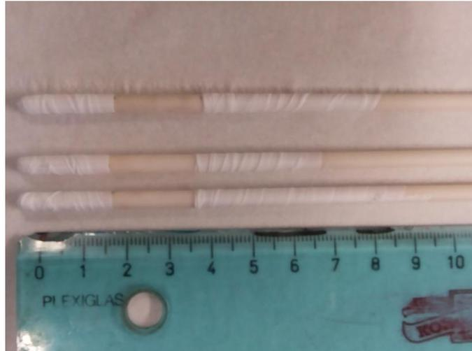
**Figura 5.5:** Tubos de alumina sinterizada com região a ser depositada, delimitada por Teflon.
