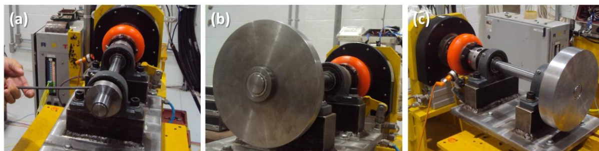
Figura 4.17 – Montagens com as configurações: (a) sem disco; (b) disco D20; (c) disco D40.
