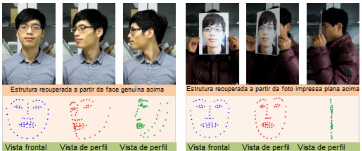
Figura 3.16 Uma comparação das estruturas de faces em 3D esparsa entre face genuína e falsa. Existem diferenças significativas nessas estruturas recuperadas, que pode ser observado pela extração de características na região da face. Imagem retirada de (WANG et al., 2013).
