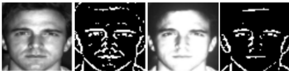
Figura 3.9 Exemplos de filtro DoG utilizado nas imagens de face. Da esquerda para a direita: imagem de face original, sua representação DoG, imagem de face falsa feita por uma foto exibida no monitor, sua representação DoG. Imagem retirada de (PEIXOTO; MICHELASSI; ROCHA, 2011).
