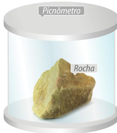
Figura 4.1: Picnômetro de água vendo-se uma amostra no interior do cilindro transparente
