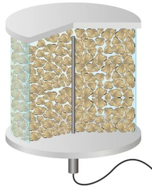
Figura 4.4: Ilustração do sensor agulha introduzido na amostra de grãos de rocha saturados com ar.
