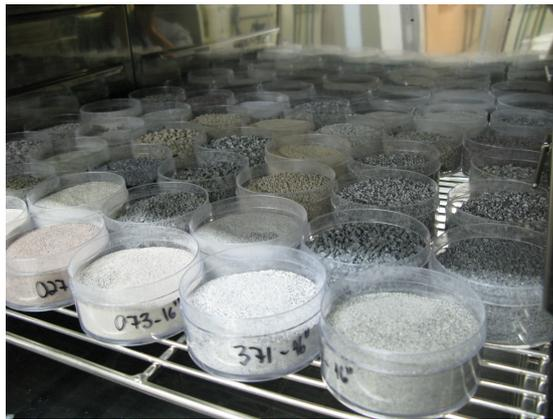
Figura 4.2: Amostras fragmentadas em diferentes granulometrias para inserção dos hospedeiros parafina e resina cristal. Para cada amostra foram avaliadas três granulometrias distintas.
