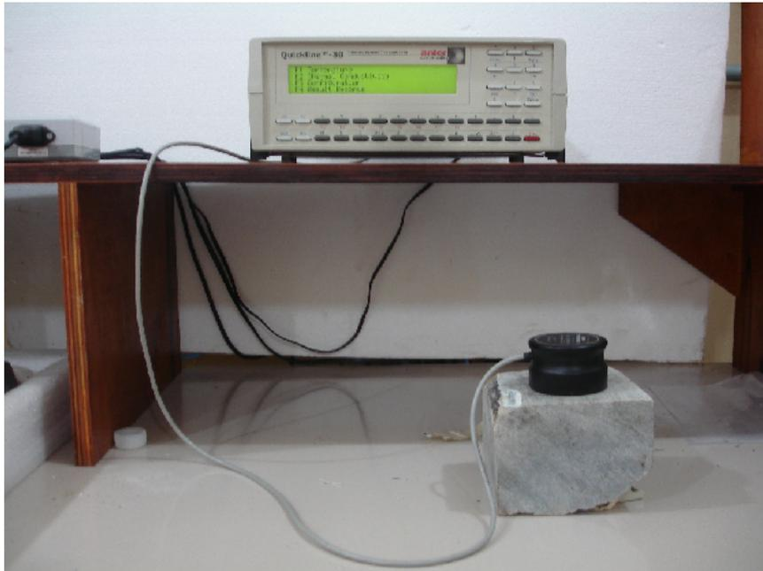
Figura 4.3: Analisador Quickline TM-30 na medida de propriedades térmicas. Observa-se o sensor planar sobre a amostra.
