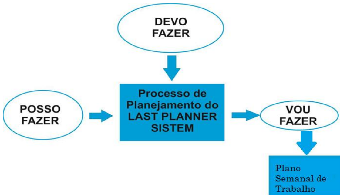
Figura 7 – Formação dos comprometerimentos no sistema Last Planner. Fonte: BORTOLAZZA(2006) adaptado pela autora.
