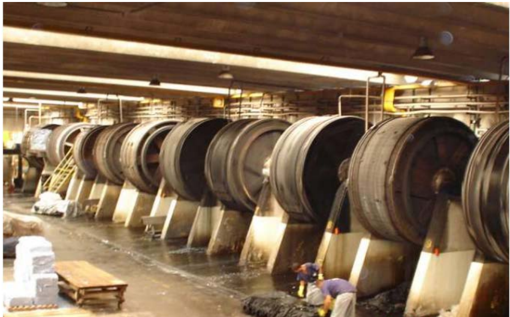
Figura 12: Bateria de fulões e operários manuseando lote de couros recém-saído da etapa de processamento, para a sequência das operações [47].
