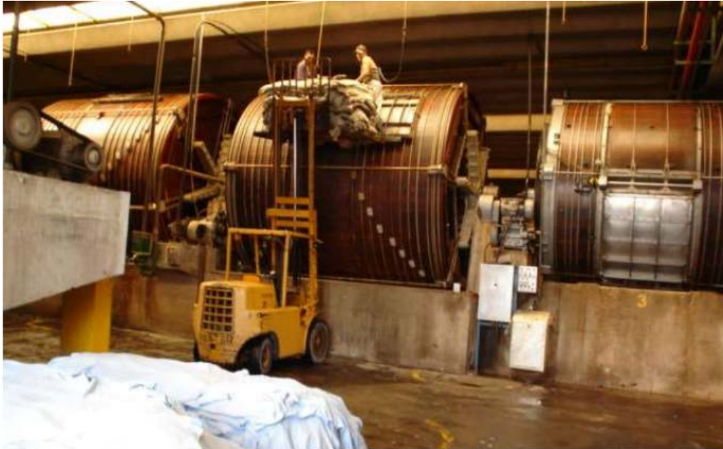
Figura 11: Grupo de fulões – operação de carga de peles para processamento [47].
