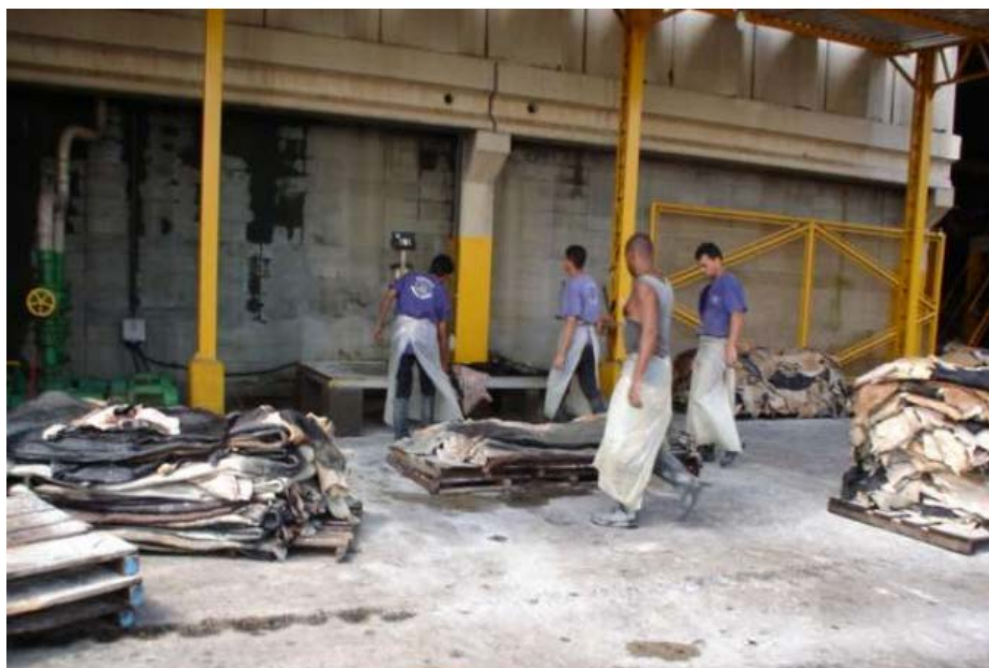
Figura 10: Separação, pesagem e montagem dos lotes de peles para início do seu processamento (pré-remolho ou remolho) [47].
