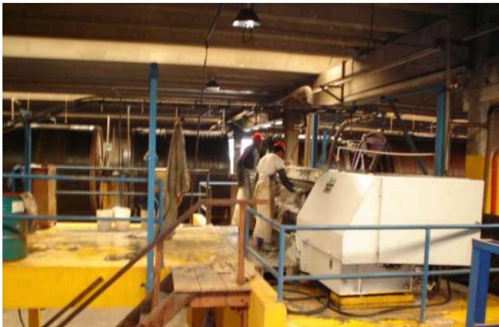
Figura 13: Máquina descarnadeira – remoção da carnaça aderida à superfície interior ou inferior das peles [47].
