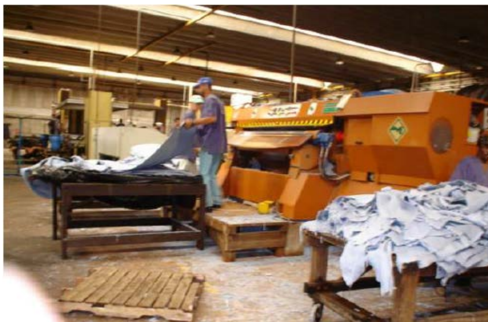
Figura 16: Máquina da seção de rebaixadeiras – rebaixamento dos couros recém curtidos ao cromo ( wet blue ) para ajuste de sua espessura [47].
