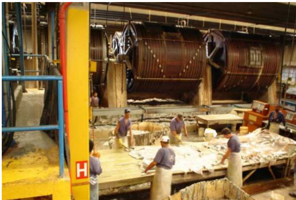
Figura 14: Operação de divisão e ajuste das extremidades das peles, após descarte e/ou divisão [47].
