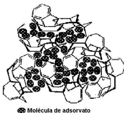
Figura 2.9. Modelo de carvão ativado com moléculas de adsorvato ocupando as microporosidades (PATRICK, 1995).
