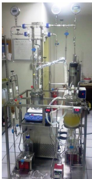
Figura 17 - Sistema reacional de fluxo semicontínuo com reator de membrana em escala de bancada.
