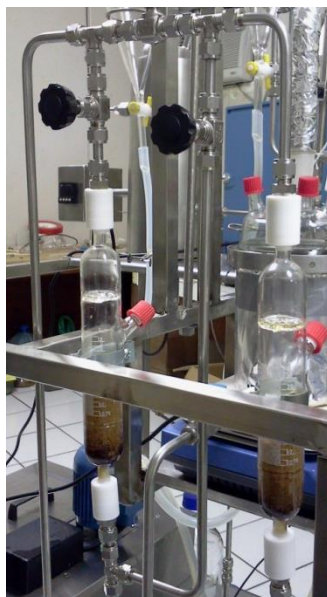
Figura 16 - Sistema de purificação com resina de troca iônica AMBERLITE BD10DRY®.
