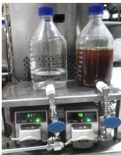
Figura 11 - Sistema de abastecimento.
