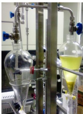
Figura 14 - Sistema de decantação.
