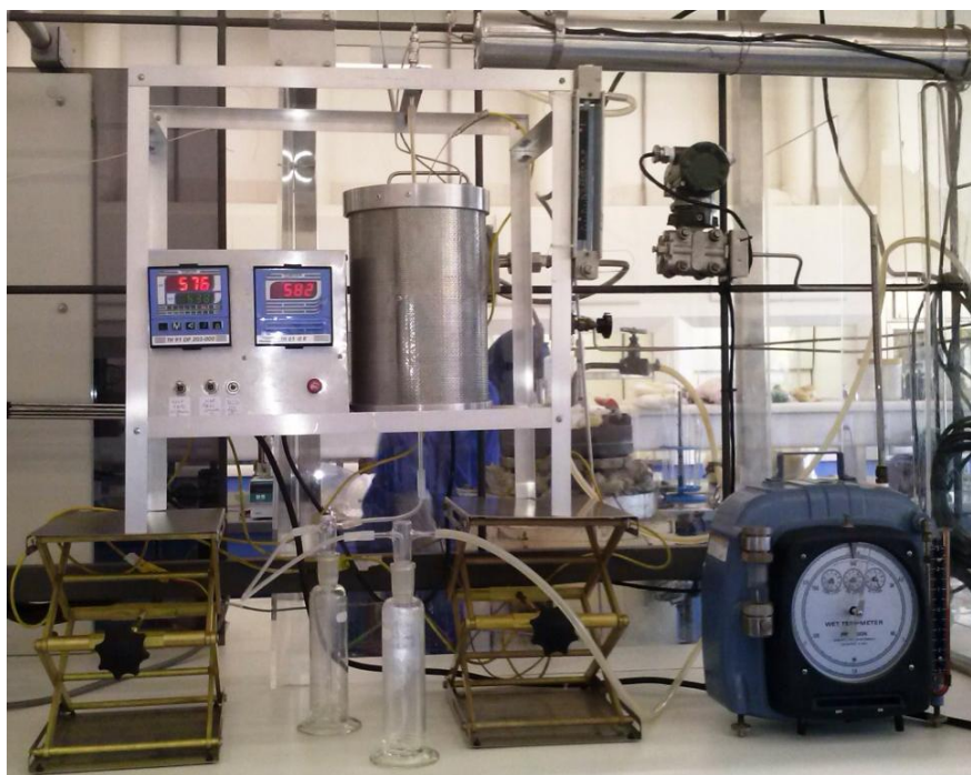
Figura 19. Unidade do teste catalítico usado na avaliação dos catalisadores.
