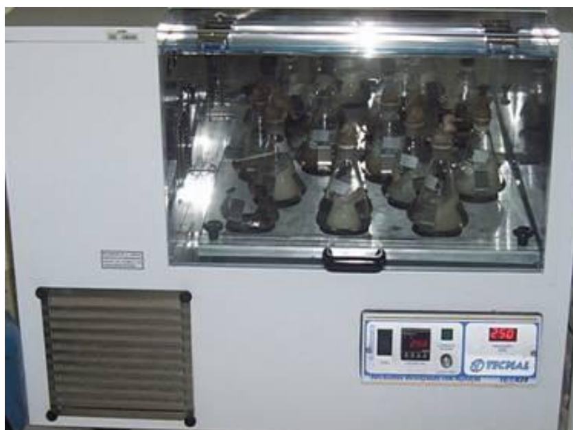
Figura 10. Ilustração do shaker utilizado nas etapas de produção de células (inóculo) e de produção de goma xantana.
